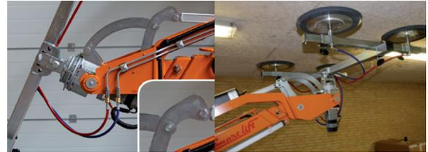
La tête de levage dispose de deux options de réglage via deux trous pour le verrou. Elle peut ainsi être ajustée pour pivoter un peu plus vers le plafond ou le plancher
