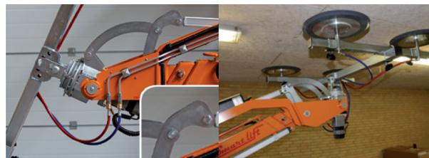
La tête de levage dispose de deux options de réglage via deux trous pour le verrou. Elle peut ainsi être ajustée pour pivoter un peu plus vers le plafond ou le plancher
